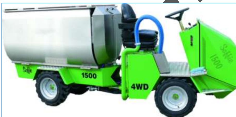
Fot.5 Karmiarka o napędzie spalinowym do rozwożenia paszy dla zwierząt
